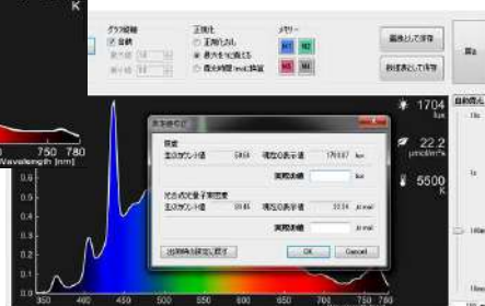
エネルギー測定モード 照度 Lux、PPFD 光合成光量子束密度 \mu\text{mol}/\text{m}^2/\text{s} 、色温度 K
